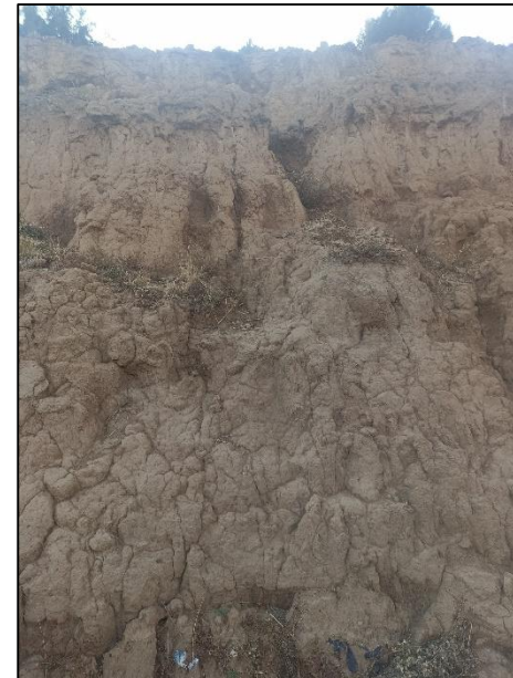
Fotografía 22. Toba alterada con tendencia a caer.
