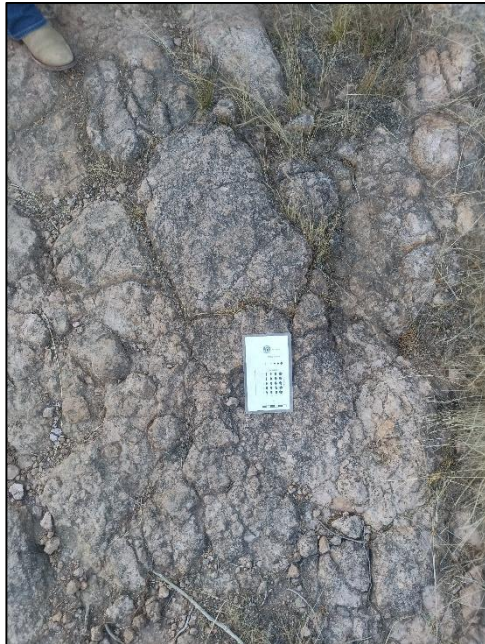
Fotografía 43. Matriz alterada y fragmentada de andesita.
