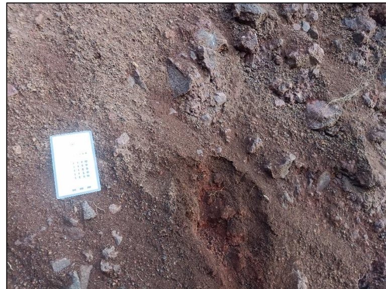
Fotografía 20. Matriz de ceniza con escoria y clastos angulosos.
