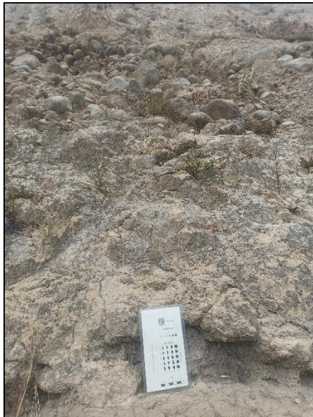
Fotografía 17. Matriz limo-arenosa con arenas gruesas y gravas.
