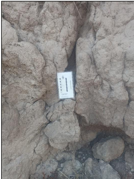
Fotografía 23. Matriz limo-arenosas con alteración.
